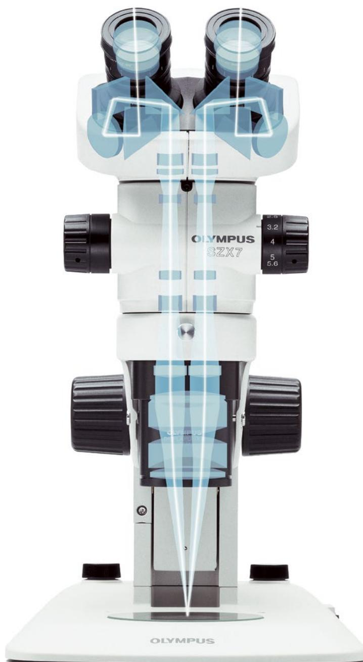
El sistema óptico Galileo incorpora dos trayectorias ópticas de aumento (zoom) independientes y paralelas (derecha/izquierda). Este sistema permite lograr un rendimiento óptico muy alto y la modularidad del sistema.
